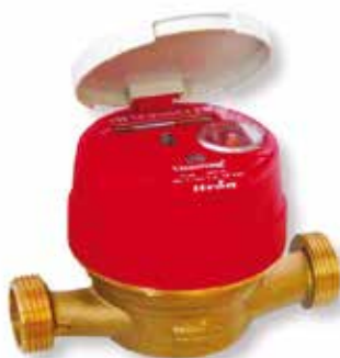
Fig.70 Hidrômetro de água quente Itron UNIMAG. Esse modelo possui temperatura máxima de trabalho de 90°C e pressão máxima admissível de 16 bar.
